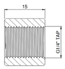
SECTION A-A Unit:mm
